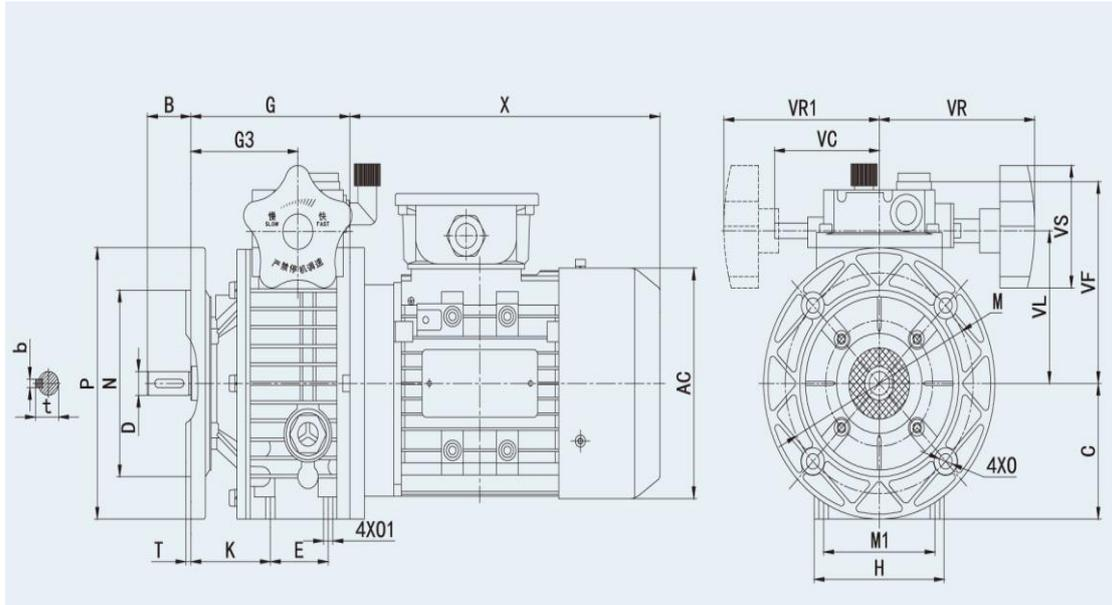
UDL-B5型机座安装形式 / UDL - B5 type frame installation form
