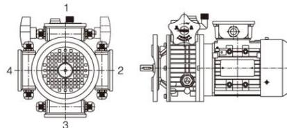
注:如没有特别说明,手轮将按照如图1位和B3安装方位的组合方式提供。
