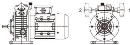
电机接线盒位置 MOTOR TERMINAL BOX POSITION
